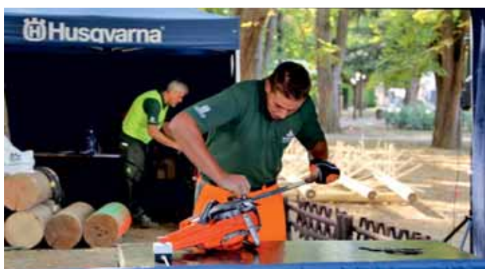
Окретање водилице и замена ланца – јуниорски рејзентни ајшвац Стефан Гвозденовић
